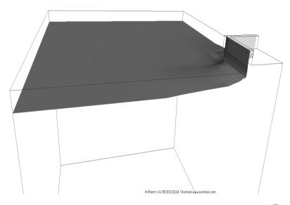
Ryc. 4: Izo-powierzchnia dla temperatury 0°C w dniu 8 lutego, 8<sup>00</sup> Fig.4: Isosurface for 0 °C, February, 8<sup>th</sup>, 8<sup>00</sup>
