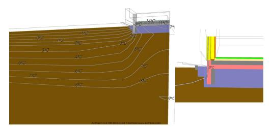
Ryc. 3: Wizualizacja rozkładu temperatury (izotermy) w dniu 8 lutego, 8<sup>00</sup>, przekrój poprzez ścianę zewnętrzną i płytę fundamentu.
